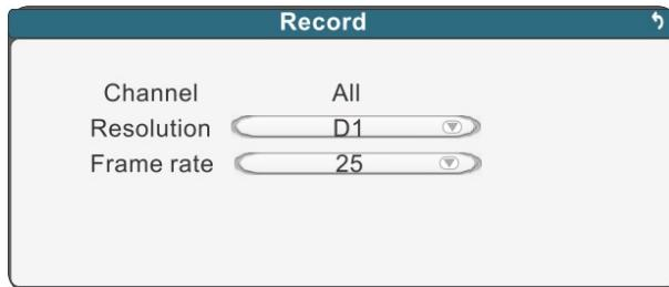
Параметры записи можно настроить только для всех каналов одновременно. Выберите требуемое разрешение записи в строке параметра Resolution (Разрешение). Для выбора доступно одно из двух значений - D1 (720x576) или CIF (352x288). В строке параметра Frame rate (Частота кадров) задаётся требуемая частота кадров видеозаписи, диапазон значений 3-25 к/с для стандарта PAL (3-30 к/с для NTSC). Система способна записывать одновременно до 100 (120) к/с в разрешении D1 или CIF.
