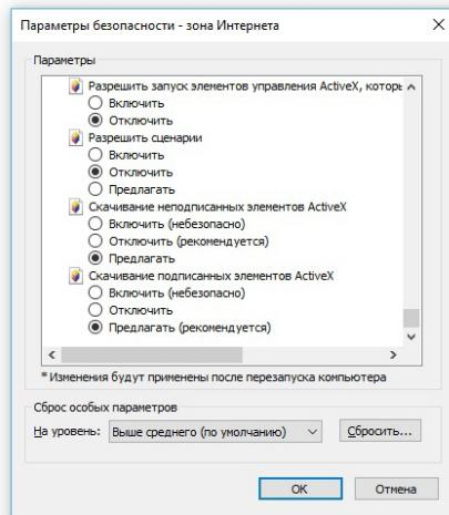
После настройки параметров безопасности следует убедиться, что монитор и компьютер находятся в одной сети. Проверить это проще всего с помощью служебной команды «ping» и командной строки (утилиты cmd). Нужно запустить командную строку (Пуск-Выполнить-cmd или Пуск - Найти - cmd) и в открывшемся окне ввести «ping 192.168.1.88», где 192.168.1.88 - текущий IP-адрес вашего
