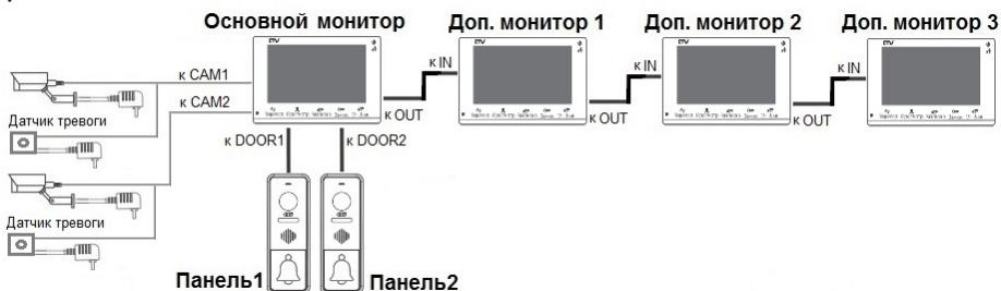
Вызывные панели подключаются только к основному монитору.
