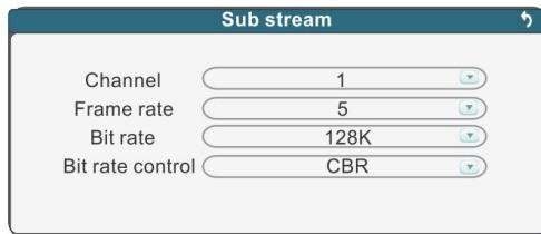
Channel (Канал) - выбор видеоканала, для которого настраиваются параметры дополнительного потока, доступны опции 1,2,3,4 и «Все».
