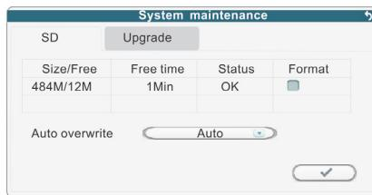
Для обновления прошивки следует использовать карту microSD, предварительно отформатированную в мониторе. Её следует вынуть из монитора и подключить к компьютеру. В корневом каталоге карты нужно создать новую папку и назвать её «ivrupgrade», затем скопировать в эту папку файл прошивки. После этого, следует установить карту обратно в монитор и нажать кнопку для запуска процедуры обновления. Обновление длится около пяти минут, после завершения процедуры монитор автоматически перезагрузится.
