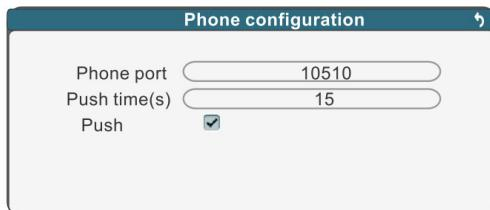
Phone port (Моб. порт) - мобильный порт, который используется для подключения к монитору с мобильного телефона. По умолчанию имеет значение 10510, при необходимости можно изменить на другой из диапазона 1024-65535.
