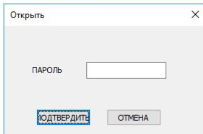
Для открывания замка нужно ввести корректный пароль пользователя и нажать на кнопку «Подтвердить». После этого замок откроется и появится уведомление: «Замок открыт!». Если пароль введён неправильно, то замок не откроется и на экране появится уведомление: «Не удалось открыть замок!».
