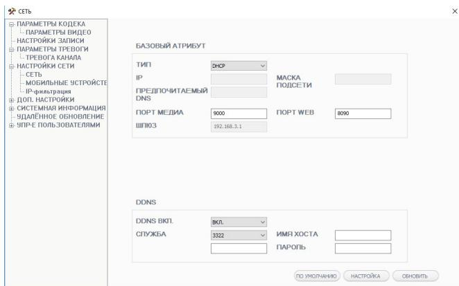
Здесь настраиваются такие сетевые параметры устройства, как тип присвоения IP-адреса (DHCP или вручную), IP-адрес, маска подсети, шлюз, DNS, WEB-порт и медиа порт. Также здесь включается и настраивается служба DDNS.
