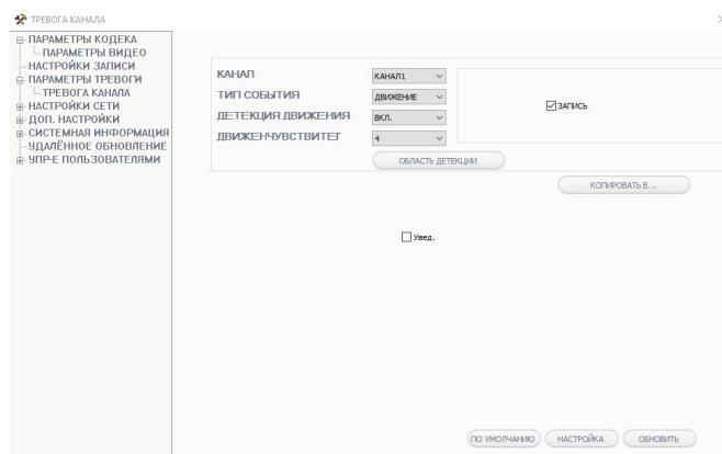
Здесь пользователь может включить и настроить детекцию движения по каждому каналу, указать область детекции и чувствительность детектора движения. Также здесь включается/выключается функция PUSH-уведомления на связанное мобильное устройство, для этого используется параметр «Увед.».
