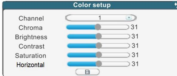
Здесь доступны для регулировки такие параметры изображения, как Chroma (Тон), Brightness (Яркость), Contrast (Контраст), Saturation (Насыщенность) и Horizontal (Сдвиг по горизонтали). По умолчанию, все параметры имеют значение 31 (среднее значение). Отрегулируйте параметры изображения для выбранного канала в зависимости от условий освещения и для сохранения изменений нажмите на значок «Сохранить», расположенного под регулировками.
